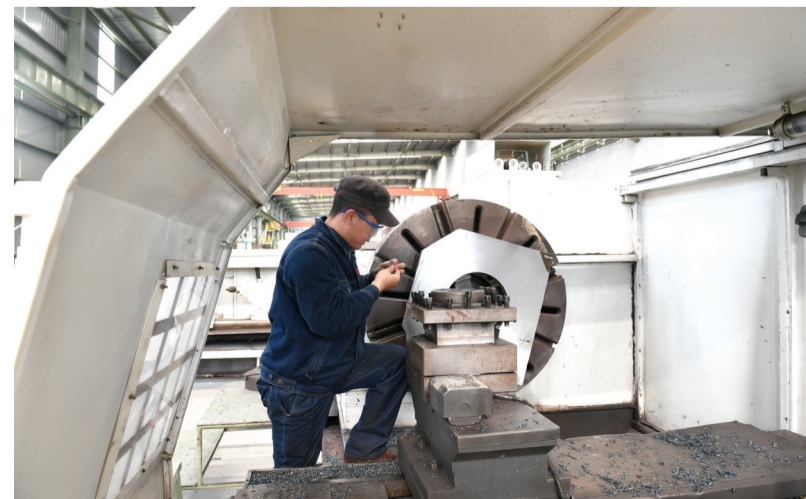
攀钢新钢业攀新机电设备公司加工中心数控车床操作工在加工轴承装置备件。该公司利用自身加工中心平台优势,积极拓展精密铸件生产、大型铸锻件制作等机械加工业务,全面跟踪用户需求,科学编制加工计划,保障各类加工件合同兑现,持续为用户提供优质服务。
