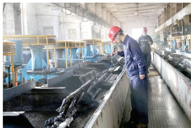
鞍钢矿业齐大山选矿厂一选作业区职工正在观察浮选泡沫状态。今年以来,该厂持续优化生产组织,努力抓好在线生产,通过加强采场源头管控、细化“以破代磨”等措施,全力攻克产线瓶颈,充分释放产能、提升质量,确保稳产增产、提质增效。
