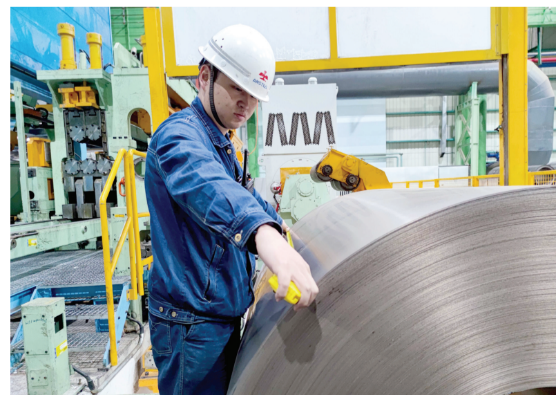
西昌钢板厂职工正在检测带钢尺寸精度。今年以来，该厂坚持目标导向，持续加大钢铁共线可逆式轧机产线达产达效攻关力度，结合实际精心协调组织生产，持续提升生产效率和产品质量，为生产经营稳定顺行提供强力支撑。
