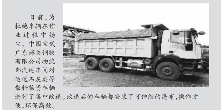
日前,为杜绝车辆在作业过程中扬尘,中国宝武广东韶关钢铁有限公司物流部汽运车间对运送石灰类等散料物资车辆进行了集中改造。改造后的车辆都安装了可伸缩的篷布,操作方便,环保高效。
