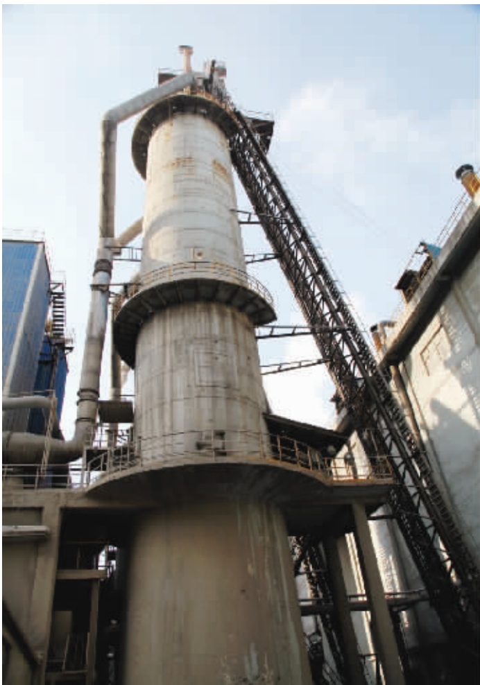
机械化竖窑——用于生产炼钢轻烧白云石。
